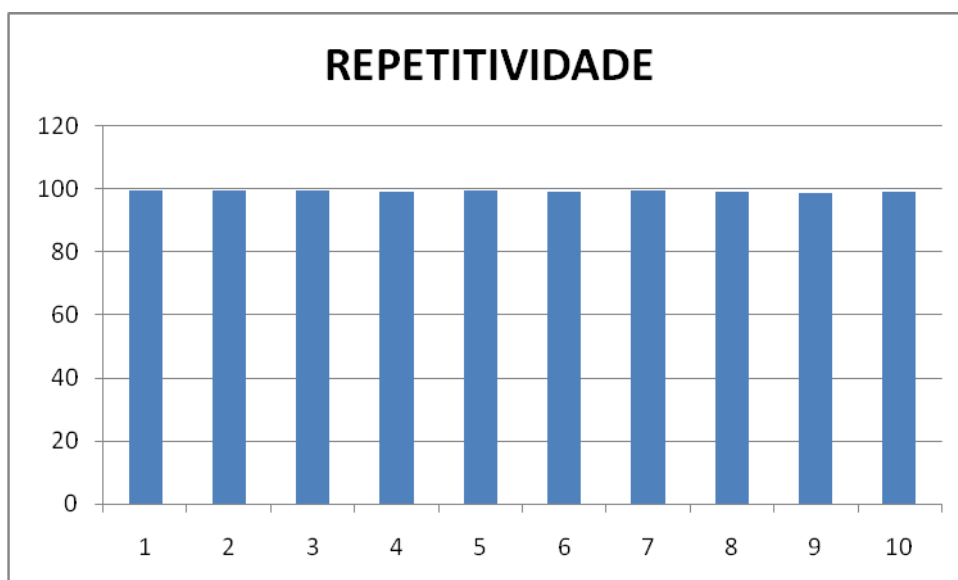
Figura 10 – Determinação da precisão por repetitividade, n= 10 para massa adicionada de 30 mg.
