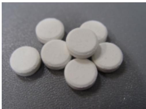
**Figura 33:** Comprimidos obtidos do GLE-amido
