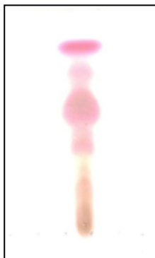
Figura 10: Cromatograma do óleo essencial de M. alternifolia . Sistema eluente: hexano:acetato de etila (8:2; v/v). Revelador: anisaldeído sulfúrico/UV.
