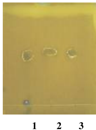
Figura 2. Cromatograma em camada delgada de solução de digluconato de clorexidina. (1) solução de referência, (2), solução teste, (3), solução padrão secundário, no sistema solvente: acetato de etila: amônia concentrada: água: etanol (1:1:3:5, V:V:V:V). Valor de Rf da solução referência é 0,56, Rf da solução padrão é 0,60 e Rf da solução teste é 0,60.
